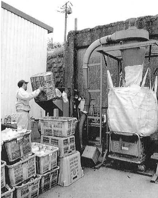
ペットボトルを粉砕機で細かく粉砕し、袋詰めしていきます。一袋は、約200g。
